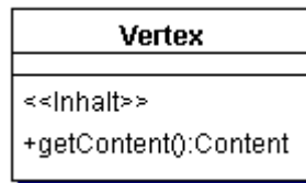
Abbildung 23: Zugriff auf den Inhalt eines Knotens (UML-Klassendiagramm)
