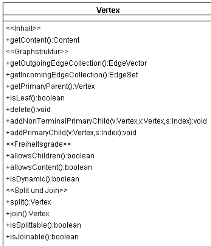
Abbildung 30: Split- und Join-Operation (UML-Klassendiagramm)
